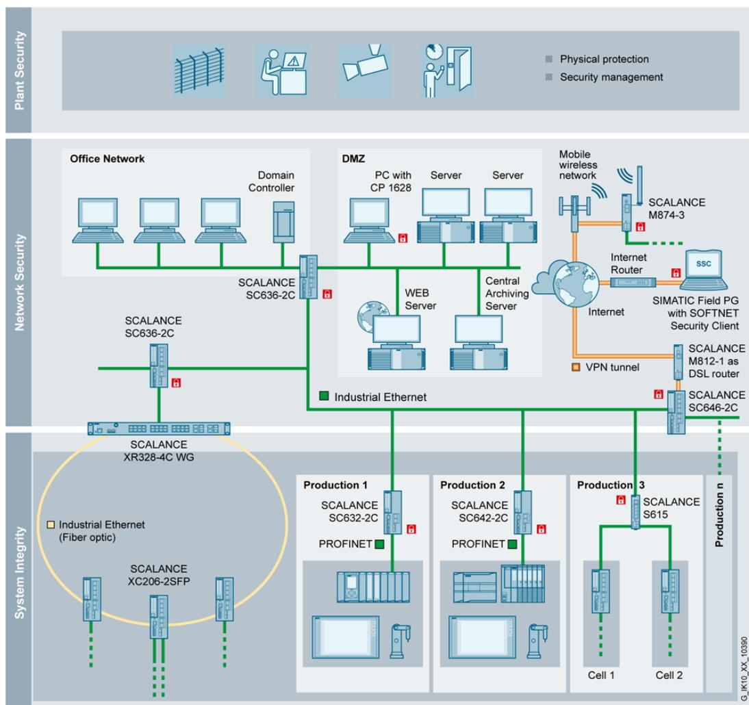
Abbildung 1: Netzwerksegmentierung nach IEC 62443; Quelle: industrial ethernet book; Aktualisierte Version von Siemens AG, DI CM IP vom 14.06.2019
